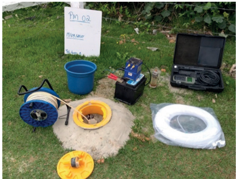
Figura 50: Estação de amostragem disposta de medidor de nível, bomba, mangueira coletora e sensor multiparâmetro.
