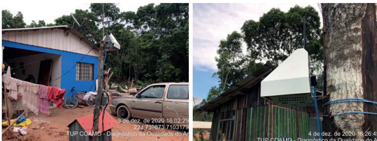
Figura 52: Posicionamento dos equipamentos de medição nos pontos P2 e P3.
