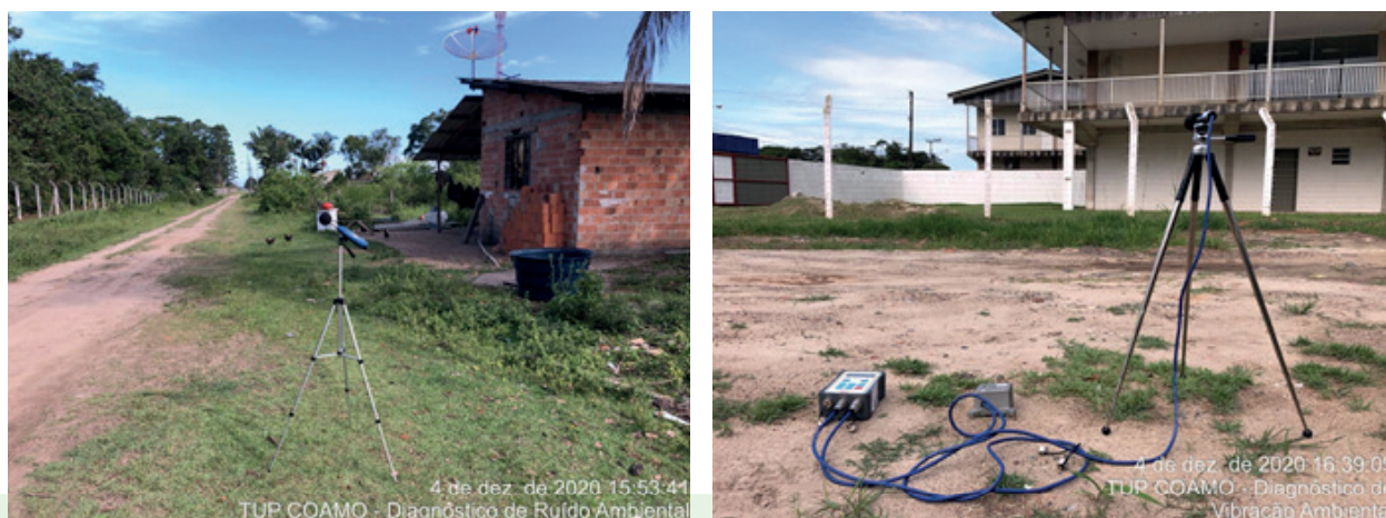
Figura 51: Posicionamento dos equipamentos de medição de a) ruído e b) vibração no ponto P3.
