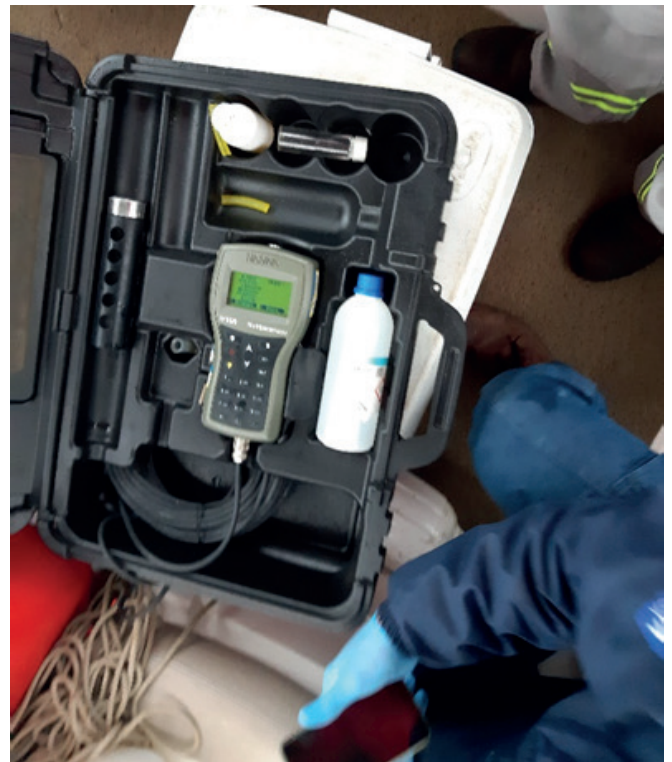
Figura 49: a) lançamento da garrafa Van Dorn; b) Sensor multiparâmetro HANNA utilizado para a obtenção de dados in situ.
